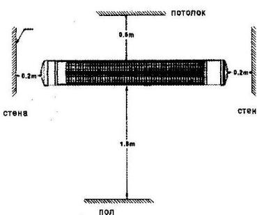
Прибор должен быть установлен НЕ МЕНЕЕ 1.8м от пола, 0.5м от потолка и 20 см от стены или прилегающих поверхностей.
