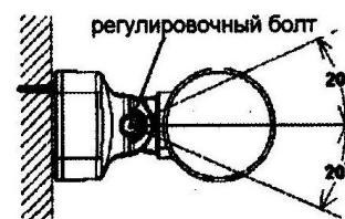
5. Регулировать положение прибора можно с помощью регулировочного винта (см. рисунок выше).
