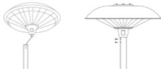
**6. Вытяните шнур питания с основания обогревателя. Зафиксируйте его с помощью гаек**
