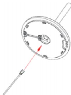
**4. Подключите соединительный шнур к разъему в верхней части обогревателя**
