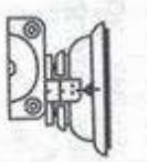
Переведите фиксатор баллона в положение LOCK.
