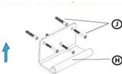
1) Используйте втулки монтажа (3 x J) для закрепления монтажного кронштейна (H) на стене вертикально точно так же, (см. рисунок слева).
