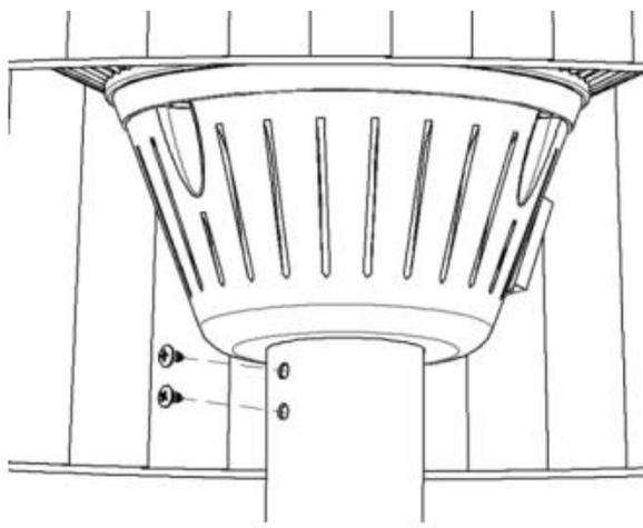
6. Закрепите кабель питания с помощью винтов 4\*12 мм
