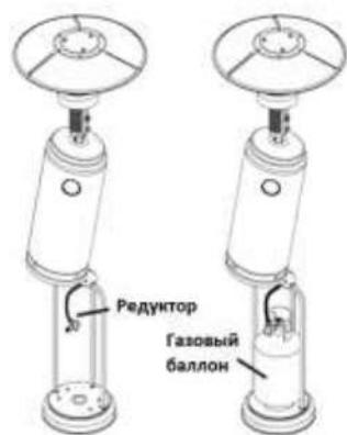
7. Чтобы установить баллон с газом, поднимите кожух.
