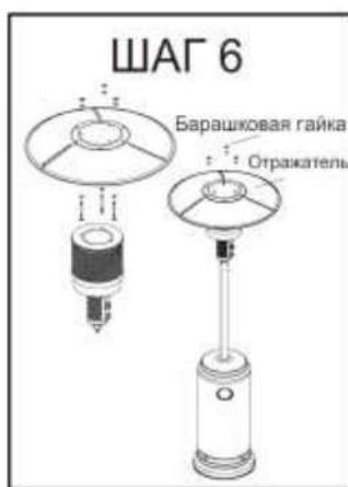
6. Наденьте на горелку рефлектор и закрепите его гайками – барашками.
