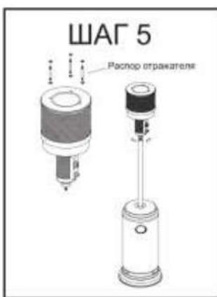
5. Убедитесь, что монтаж соединения вертикальной стойки и горелки выполнен в соответствии с инструкциями, и все болты и гайки затянуты. Установите 6 больших плоских шайб на 3-х распорах.
