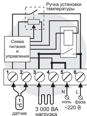
Схема 1. Схема подключения и упрощенная внутренняя схема
