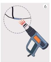
После этого обожмите соединение при помощи промышленного фена при температуре +350 °C.
